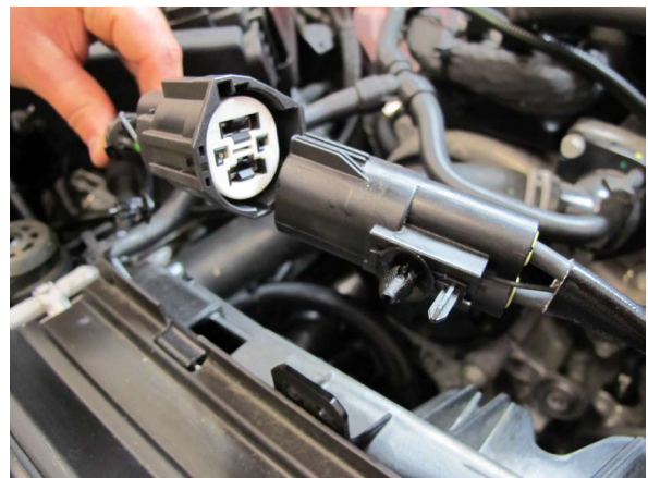
Fig. 3-i: Unplug Electric Fan
